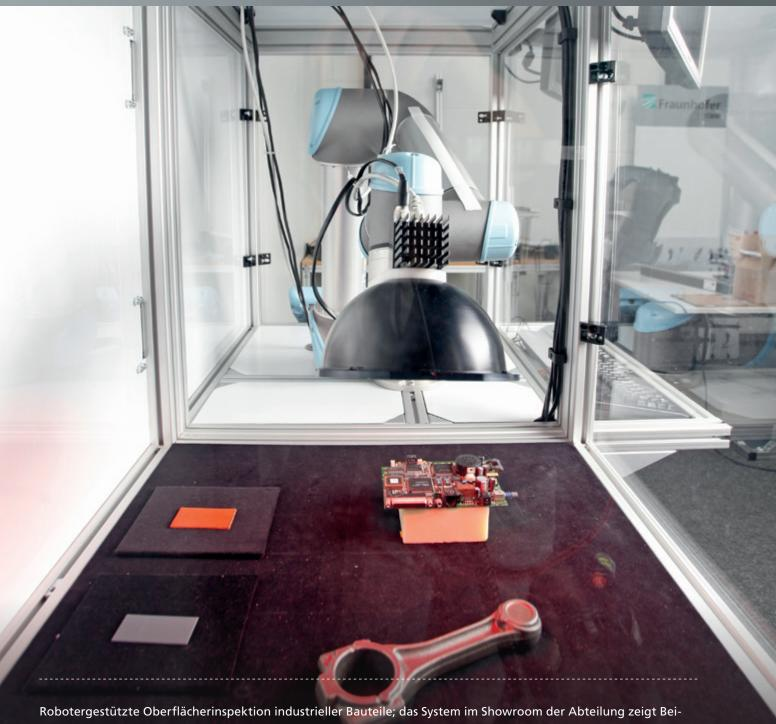
Robotergestützte Oberflächerinspektion industrieller Bauteile; das System im Showroom der Abteilung zeigt Beispiele für verschiedene Materialien (Leder, Kunststoff, Guss), die sowohl zweidimensional als auch dreidimensional geprüft werden können.
